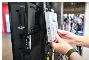
本体底面に強力なマグネットを装備しており、金属面へ簡単に固定できます。AV ラック、ディスプレイスタンド、筐体内など、限られたスペースでの固定に大変便利です。付属のマウント金具もマグネットで固定できます。
