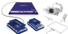
ジェスチャー、色、光などを感知するセンサーによりサイネージの表示を切り替える各種オプションモジュールや、GPIO で接続してボタンでサイネージをコントロールするスイッチボックスなどをラインナップしています。プログラム開発の必要がなく、ユニークなインタラクティブサイネージを簡単に実現できます。詳細は[こちら](#)
