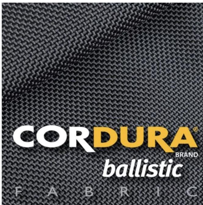
ボディには摩耗・引裂に強い防水耐熱素材のCordura®社バリスティックナイロン1680Dを採用
