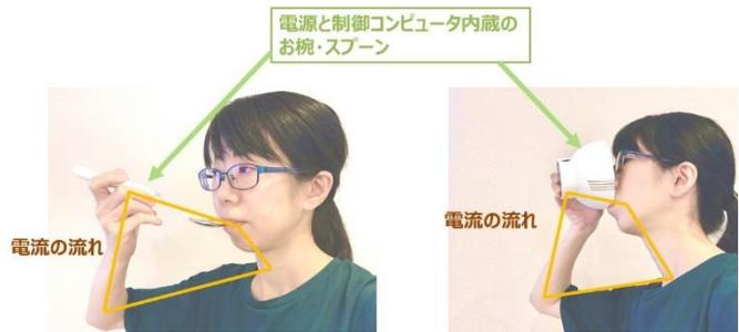
「エレキソルト」デバイス使用時の電流の流れ方
