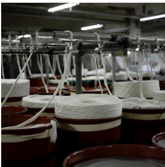
原糸となった状態で、さらに強度を出したり、糸自体に表情を加えたりするために「撚糸」という工程を踏みます。原糸を撚り合わせるというプロセスです。単一から複数本まで何通りもの組み合わせがあります。短繊維が含まれる反毛糸に強度や均整を加えるため、また素材の表情を引き出し、目指している生地質感にたどり着くため、撚糸にも拘っています。
