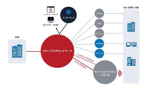
VECTANT クローズド IP ネットワークはマルチキャリアの強みを生かし、自社回線だけでなく NTT フレッツ、KDDI、ソフトバンクなどの様々なアクセス回線を組み合わせた冗長構成を採用することでキャリア・ダイバーシティによる安全かつ安定したネットワークを実現することができるサービスです。
