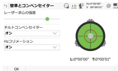
電源を入れると電子気泡管が表示されます。整準ネジを廻しながら気泡を中心に入れてください。電子気泡は本体に装着されている円形気泡管より感度が高いため、常に動いていますが円の範囲内に入っていれば、測定に影響しません。OK を押して先へ進みます。
