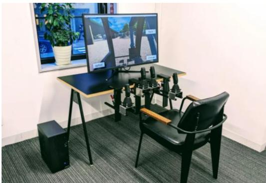
建機等の大型機械の実証実験する際の事故発生リスクを低減するために、現場環境を再現するためのシミュレータを国内で開発しました。
