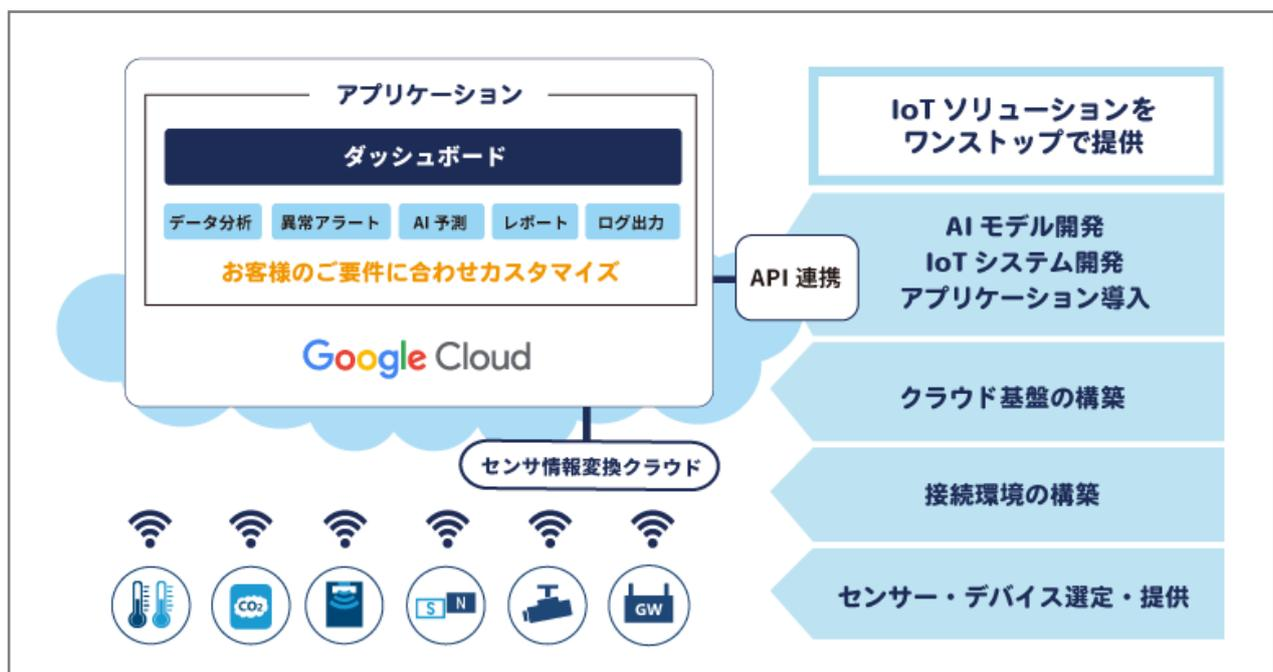
また、各センサーの属性(温度センサー、湿度センサーなど)が同一であってもメーカーが異なることで、同一種別として認識できないためにプラットフォームの追加開発が必要でしたが、MAIDOA plus はセンサーから受信したデータに種別情報を付与して中継ノードで種別情報を振り分けることで、異なるメーカーのセンサーデータでも同じ属性の場合に同一種別と認識し、一元管理することが可能です。
