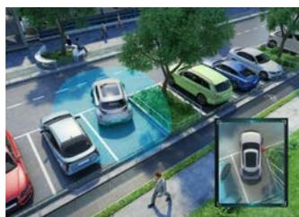
直観的で人間工学に基づいた [360Vue® 3D](#) システムは、より正確に車を操作したいと願うドライバーを助けるために設計されています。このシステムはドライバーのために、車の上方から周囲を見渡すビューをダッシュボードのスクリーンに映し出します。周囲 360° の環境が 3D で映し出されることで、車の全方位で完全な視界を実現します。
