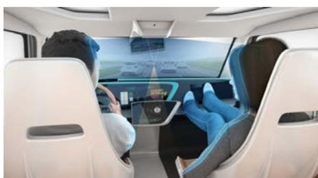
屋外エリアに展示されるヴァレオC-Streamドームモジュールは、車室内で起きていることをリアルタイムで解析します。このシステムは、ドライバーと同乗者の動きを観察する室内カメラを使って室内をマッピングし、自動運転時にはドライバーの姿勢と覚醒度合を解析します。これによって、手動運転モードに戻る前にドライバーが車のコントロールを再開するのに必要な時間を調整することが可能になり、自動運転から手動運転に移行する際の安全性が高まります。このシステムはまた、例えば子供が同乗しているかどうかなど状況に合わせてドライビングスタイルを対応させます。
