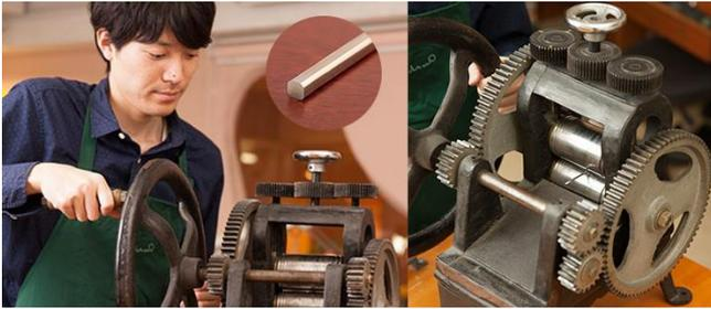
圧延ローラーで金属を伸ばし平らにする工程
