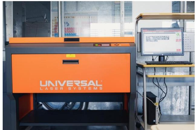
試作品の製作に利用可能なレーザー式精密加工機
