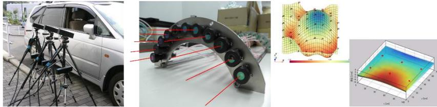
多点振動計「OptoComb MPV」ラインナップ
