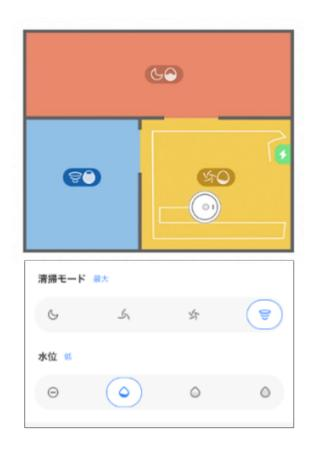
レーザーセンサーは暗闇でも正確に機能するので、夜間の稼働でも迷子になることがありません。さらに「Roborock S5 Max」は、部屋ごとに最も効率の良い経路を算出します。始めに全部屋の外周を清掃しながら部屋ごとの長辺を認識し、無駄な往復を削減するので、短時間の清掃を可能にします。
