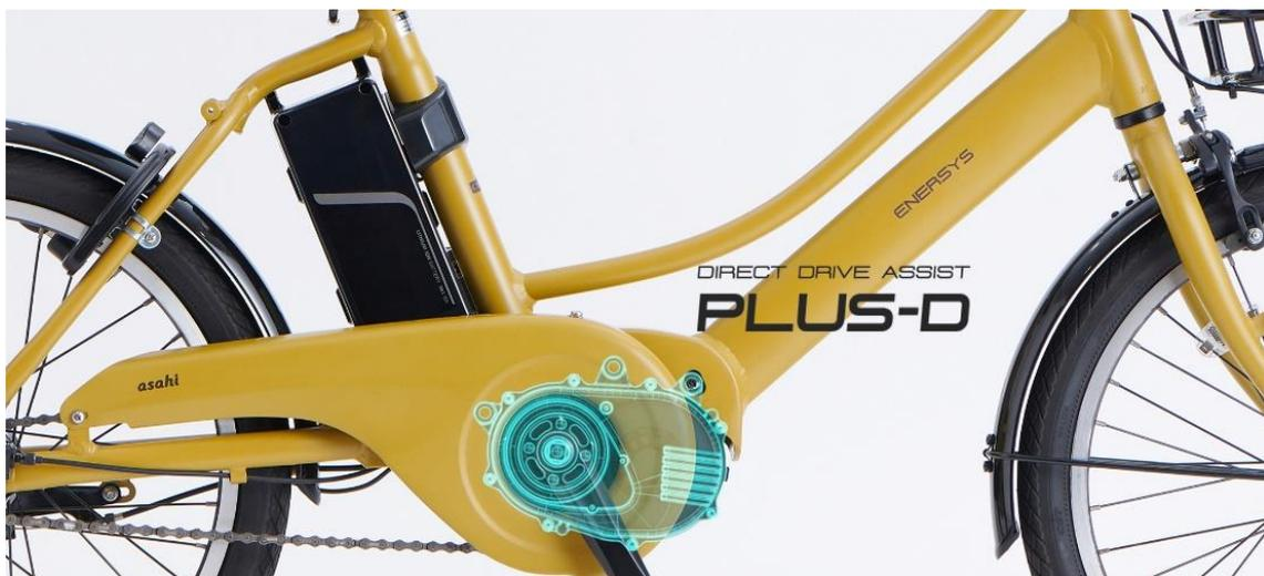
エナシスシリーズの「PLUS-D」はクランク軸の回転をモーターが直接アシストすることで、パワフルでスムーズな乗り心地を提供する最新のダイレクトドライブ方式が採用されています。また、駆動部のパーツが少なくなることで『耐久性』と『メンテナンス性』に優れています。ダイレクトドライブ方式はスポーツ電動アシスト自転車にも多く採用されている駆動方式です。
