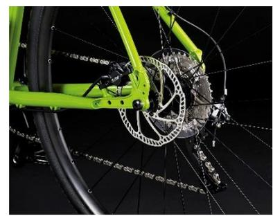
TEKTRO製の油圧式ディスクブレーキを採用。スルーアクスルを組み合わせることで安定した制動力を発揮する。
