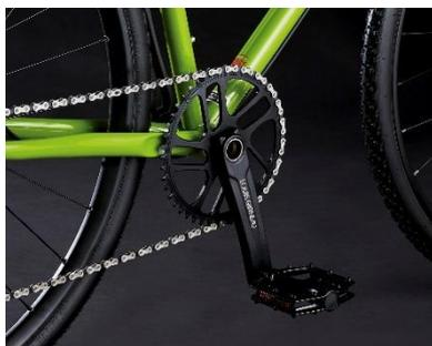
チェーントラブルの少ないナローワイドチェーンリング。クランクアームにはブランドロゴが刻印されている。
