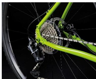
メインコンポーネントはSHIMANO製MTBミドルグレードのDEORE。正確なシフト操作が可能。
