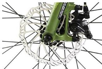
160mm径ローターを採用したメカニカルディスクブレーキは急激な天候の変化にも対応
