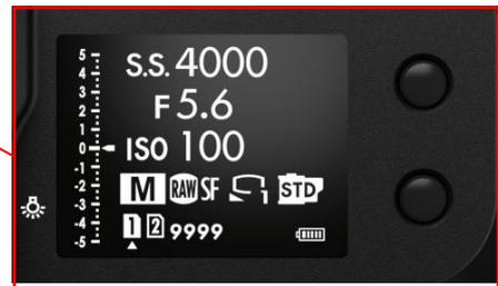
視認性に優れた 1.80 型の天面サブ液晶モニターを搭載。シャッタースピード、絞り、感度、露出などの主要な撮影情報に加え、静止画撮影時には残撮影枚数、動画撮影時には撮影時間の確認が可能。
