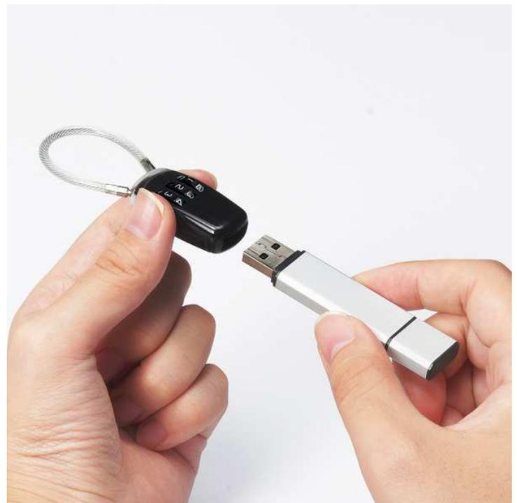
「SL-69」は、USB メモリのコネクタをロックしてデータ抜き取りを防止し、ワイヤー錠で USB メモリ本体の紛失・盗難を防ぐセキュリティ用品です。USB メモリのコネクタロックとワイヤー錠はそれぞれ独立した 3 桁のダイヤルで鍵を掛けられ、ダイヤル番号は自分で設定できます。コネクタロックとワイヤーによる二重のセキュリティ製品のため堅牢性が高く、万が一ワイヤー部分を切断され USB メモリを盗難されたとしても、データの漏えいを防ぐことができます。
