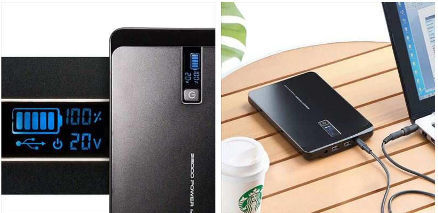
本製品は、23000mAh のバッテリー搭載でノート PC やタブレット、スマートフォンの充電に対応した大容量のモバイルバッテリーです。ノート PC の仕様に合わせて DC 出力を 5 パターンから選択でき、また 9 種類の出力変換プラグが付いているので、様々なノート PC への充電に対応します。ノート PC の他にもタブレットやスマートフォン、ゲーム機などの USB 機器への充電ができます。USB 充電ポートを 2 つ、DC 出力ポートを 1 つ備えているので、最大でノート PC とスマートフォンやタブレットなどの USB 充電機器 2 台の 3 台同時充電が可能です。大容量タイプなので、電源が取れない野外でも、アウトドアや緊急用として USB 機器に給電できます。本体には電池残量や DC 出力値の確認ができる液晶画面を搭載しています。携帯に便利なポーチ付属で、バッテリー本体の他、プラグなどの小物が入るポケット付きです。付属の AC アダプタで本体へ約 5 時間で蓄電でき、大容量にもかかわらず高速充電が可能です。
