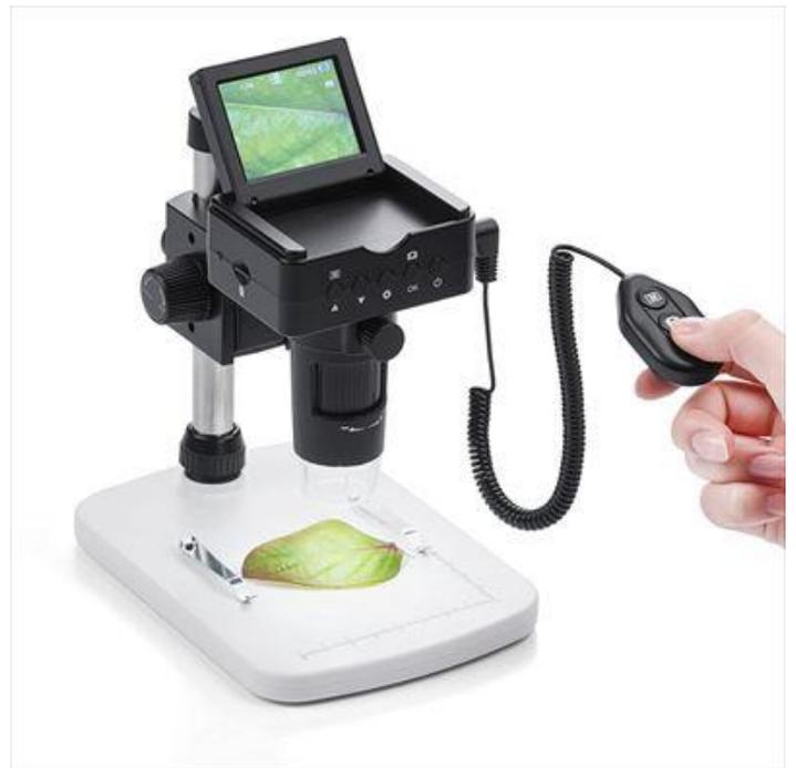
本製品は、最大 220 倍に拡大できるデジタル顕微鏡です。液晶モニターとバッテリー内蔵で、対象物を自由に観察しその場で確認できます。HDMI 出力ポートを搭載し、フル HD の高解像度でディスプレイに出力ができます。また、テレビ出力ケーブル付属で、アナログ出力にも対応しています。手持ちとスタンド固定のどちらにも対応できる、2WAY 仕様です。リモコン付属で本体への振動を減らしブレを防いで撮影することができます。さらに、スタンド付属なのでしっかり安定して観察する事ができます。花などの植物や雑誌、基盤や繊維などの拡大などに使用でき、microSD カードを挿入すれば、撮影した画像や動画を保存できます。時間による状態変化の観察に最適な、インターバル撮影にも対応しています。8 つの LED ライト搭載で、暗所や接写撮影でも明るく撮影できます。パソコンと接続可能で、microSD 未挿入
