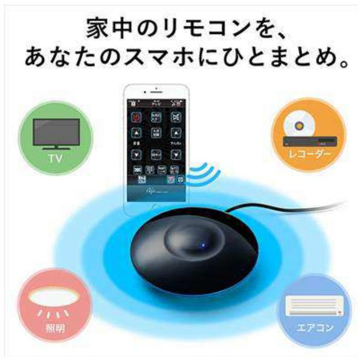
本製品は、テレビ、DVD レコーダーやブルーレイレコーダー、エアコン、照明機器などの、赤外線（IR）リモコンを使用する機器をスマートフォンで操作できる学習リモコンユニットです。リモコンが見当たらないときや、外出先からでも室内のエアコンを操作するなどが可能です。リモコンユニットとスマートフォンは Wi-Fi 経由で接続し、スマートフォンから送信された信号を受信し赤外線に変換してテレビなどへ信号を送ります。
