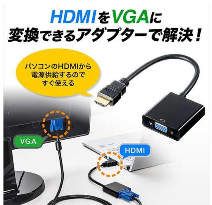
本製品は、パソコンの HDMI ポートを VGA (ミニ D-sub15pin) に変換できるアダプターです。パソコンの HDMI ポートを VGA (ミニ D-sub15pin) に変換し、VGA 入力端子を持つ液晶テレビやディスプレイ、プロジェクターなどに映像を出力することができます。ドライバや電源不要で、ケーブルを挿すだけで簡単に使用することができるので、お好みの場所でご利用頂くことができます。約 15cm のケーブル内蔵で、コネクタの接続がしやすく、ケーブルの取り回しも楽に行うことができます。パソコンの画面を大画面のディスプレイやプロジェクターに拡張、複製することができます。フル HD (1920×1080 1080p) でのアナログ信号出力に対応しています。別途オーディオケーブルを追加することで、接続したディスプレイなどから音声を出力することができます。錆にも強く経年変化による信号劣化の心配が少ない金メッキコネクタ仕様で、筐体もコンパクトサイズなので、持ち運びにも便利です。
