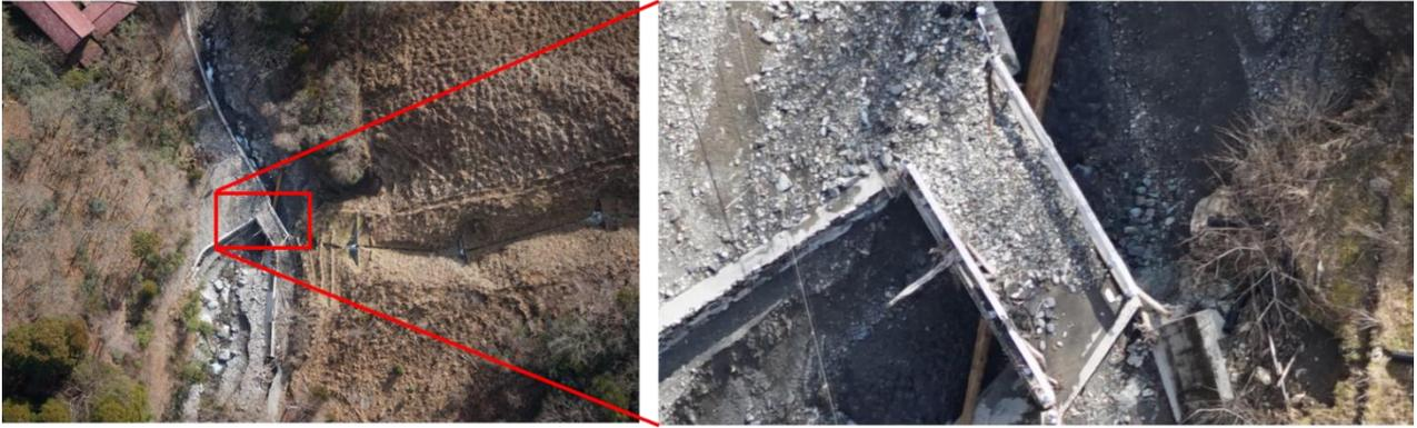
**エアロボウイングが飛行中に撮影した陥落した道路の画像（左）と拡大画像（右）**
