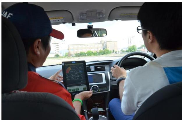
タブレット型燃費計測器による計測
